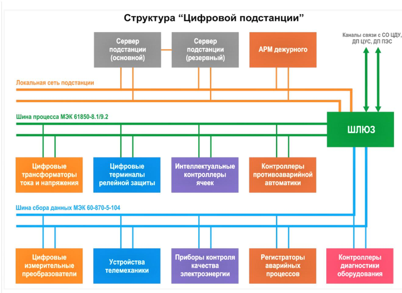
**Рис. 5** – Структура цифровой подстанции [11]
