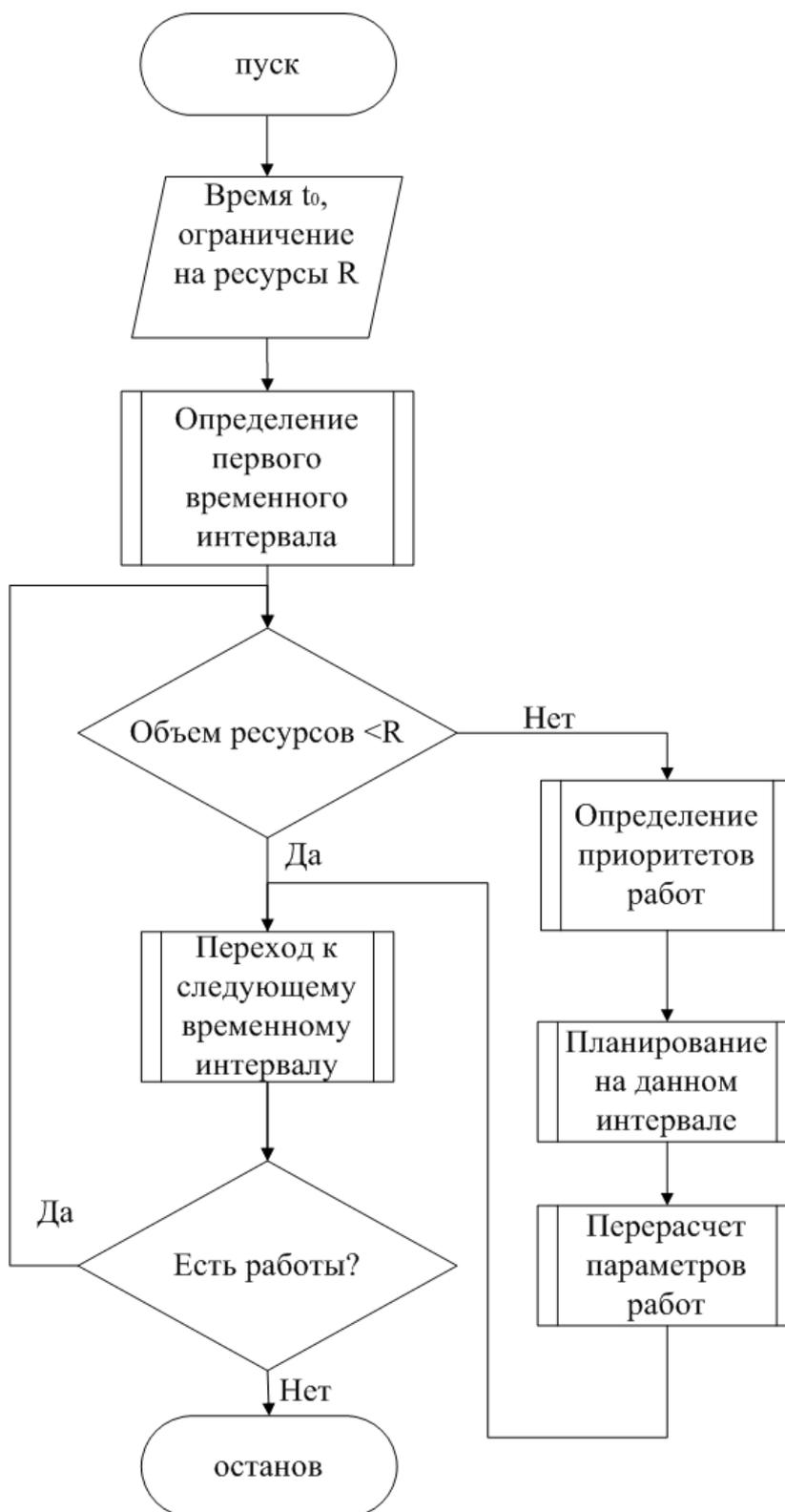
Рис. 2 – Схема алгоритма формирования план-графика
