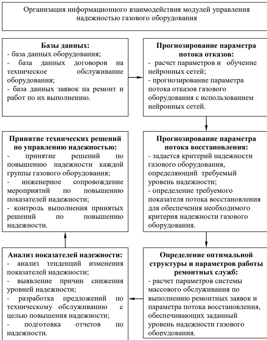
**Рис. 1** - Организация информационного взаимодействия модулей управления надежностью газового оборудования
